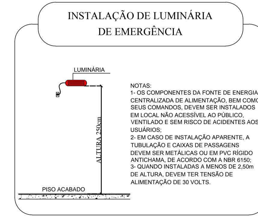
DETALHE CONFORME IT 13 ESCALA 1:50
